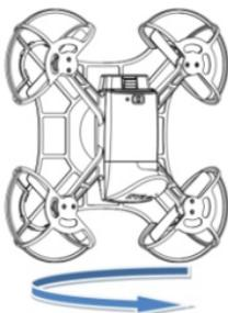
3. 드론 머리를 똑바로 유지하고(각도가 맞으면 드론의 상태 표시기가 노란색으로 바뀌고 항상 켜짐) 드론을 천천히 2-3회 회전합니다. 회전하는 동안 노란색 표시등을 항상 켜두십시오. 그렇지 않으면 드론 각도를 다시 조정하고 성공적으로 보정될 때까지 계속 회전(드론의 녹색 표시등이 약 몇 초 동안 켜짐). 만약 보정에 실패하면 드론의 빨간색 표시등이 켜지며 이 시점에서 다시 보정이 요구됩니다.
