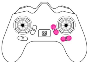
ホバリング時にドローンが特定方向に移動する場合、下のキーを押してトリムをトリム調整します。
