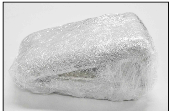
실제 부풀어 오른 폐보조배터리(좌)를 랩으로 감은(우) 사진 (다른 폐배터리의 경우에도 동일하게 적용)
