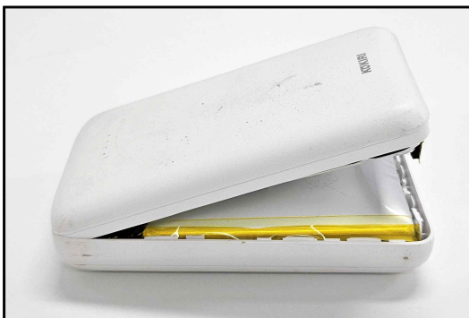
실제 부풀어 오른 폐보조배터리(좌)를 랩으로 감은(우) 사진 (다른 폐배터리의 경우에도 동일하게 적용)
