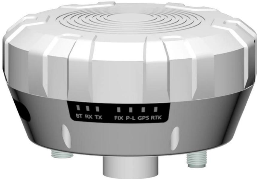
BT : Bluetooth 표시등, 빠르게 깜박이면 Bluetooth가 연결되지 않았음을 나타내고, 긴 표시등은 기지국 Bluetooth 및 앱 링크가 잘 작동합니다. RX : 기지국 라디오가 표시등을 보내고 한 번 깜박이면 기지국이 패킷을 보낸다는 의미입니다. CORS 데이터, 기지국이 정상적으로 작동할 때, 이것 ~ 주도의 ~ 해야 한다 1Hz 깜박임
