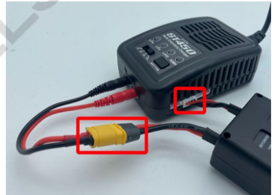
(4) 배터리의 노란색 XT60 커넥터와 밸런스 케이블을 충전기에 장착하면 LED가 점등 되면서 충전을 시작한다.
